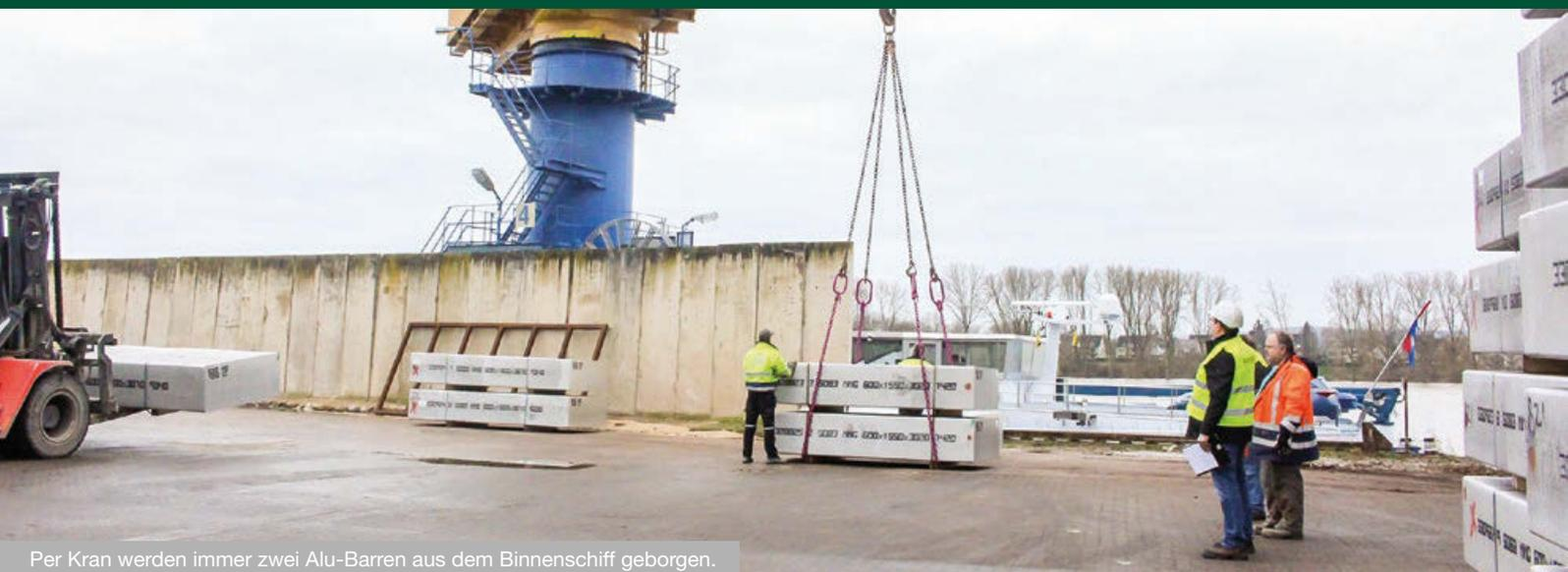
Per Kran werden immer zwei Alu-Barren aus dem Binnenschiff geborgen.
